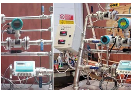
Test bench di SMERI per configurazione e controllo dei misuratori di portata
