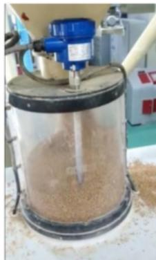
Uno dei principali produttori alimentari in Perù dovevamo controllare i variatori del sistema di macinazione, che modulano la velocità di riempimento e molitura. Il campo di misura richiesto era di 300 mm.
