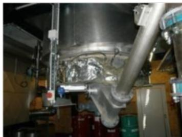
Un produttore di impianti di gassificazione a legno doveva applicare un allarme di vuoto in un reattore. Il sensore doveva rilevare in modo affidabile la cenere. La temperatura di processo arriva fino a 250°C. L'applicazione è incrostata e molto polverosa.
