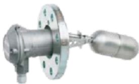
BB 31CE43 04H1E243 Flangia DIN PN16 DN80, Hastelloy C SIL2, SIL3. Esecuzione standard per temperatura fino a 150°C
