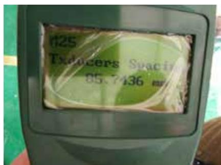
9. La distanza visualizzata è calcolata in base ai parametri inseriti. Vedi esempio di seguito per impostare correttamente la distanza dei sensori sulla staffa.
