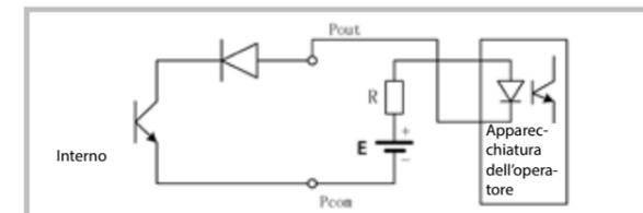
Fig. 8 Uscita digitale e connessione con raccordo fotoelettrico
