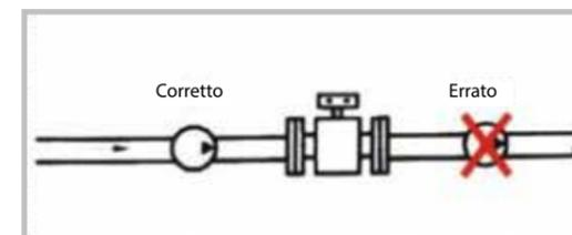
Non installare sul lato della pompa
