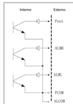
Fig. 6e Connessione del gate OC
