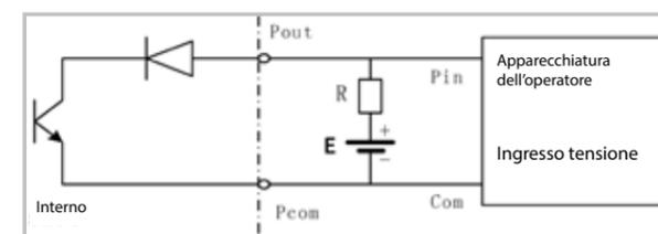
Fig. 7 Connessione dell'uscita di tensione digitale
