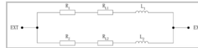
Resistenza totale =  $(R_1 + R_{L1})$  connessione in parallelo  $(R_2 + R_{L2}) \leq 120 \Omega$
