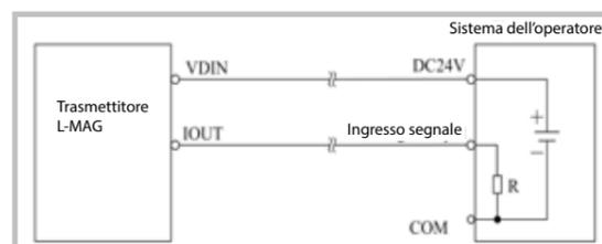
Fig. 10 Misuratore L-MAG, due connessioni
