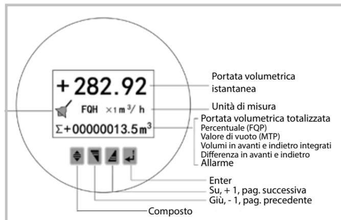
Fig. 2 Pulsanti sul grande display LCD circolare
