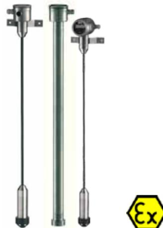
La serie sommersibile **HYDROCER** di KLAY-INSTRUMENTS comprende dei trasmettitori di livello idrostatici con cavo (IP68), che consentono di misurare il livello in acque e acque reflue, pasta di cellulosa, fanghi, soluzioni chimiche, ecc. Sono dotati di sensore ceramico capacitivo con campo fisso (tipo FR) e offrono una versione regolabile mediante protocollo HART (tipo I, accuratezza 0,1%). Questi dispositivi offrono compensazione attiva della temperatura e perfetta stabilità a lungo termine.
