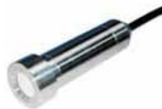
La serie sommersibile **AQUACER** di KLAY-INSTRUMENTS comprende dei trasmettitori di livello idrostatici con cavo (IP68) per la misura di livello in pozzi profondi, acque e acque reflue, ecc. Sono dotati di sensore ceramico capacitivo con campo fisso (tipo FR) e offrono una versione regolabile mediante protocollo HART (tipo I, accuratezza 0,1%). Questi dispositivi offrono compensazione attiva della temperatura e perfetta stabilità a lungo termine.
